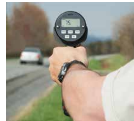
Immagine 3 - Dispositivo per misurare la velocità di marcia dei veicoli ▼
