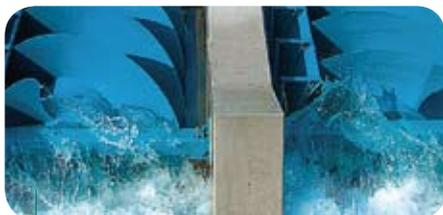
Figura 5: Coclee di un impianto ad acqua fluente
