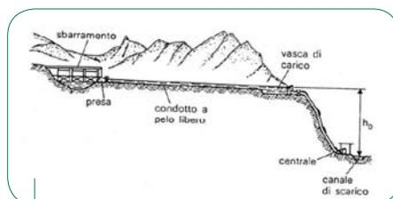
Figura 1: Classico schema di un impianto a serbatoio.
