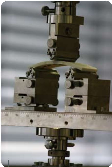
Figura 3: prova di flessione in 3 punti. Fonte IKT - Institut für Unterirdische Infrastruktur gGmbH www.ikt.de
