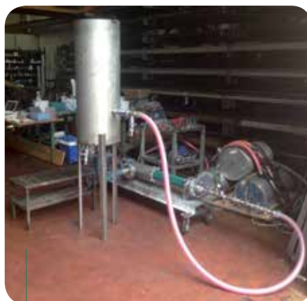
Sistema pompa-serbatoio implementato in laboratorio e dettaglio dell'inserimento di ECOWIRL®.
